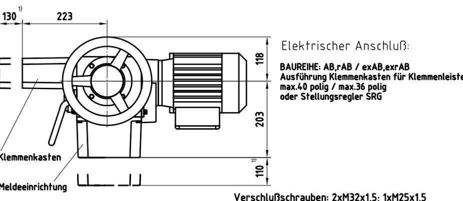
Verschlußschrauben: 2xM32x1,5; 1xM25x1,5
