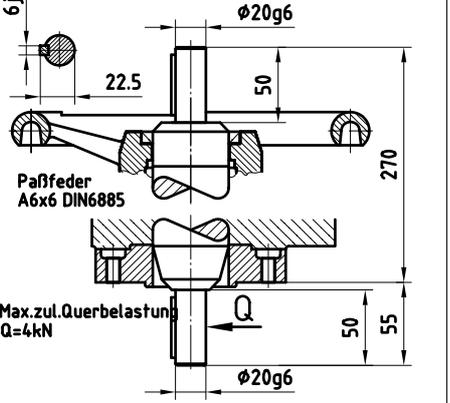
Ausführung E mit Bohrung
