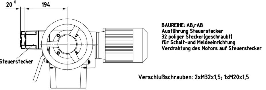
Verschlußschrauben: 2xM32x1,5; 1xM20x1,5
