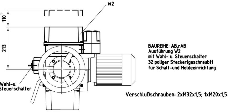
Verschlußschrauben: 2xM32x1,5; 1xM20x1,5
