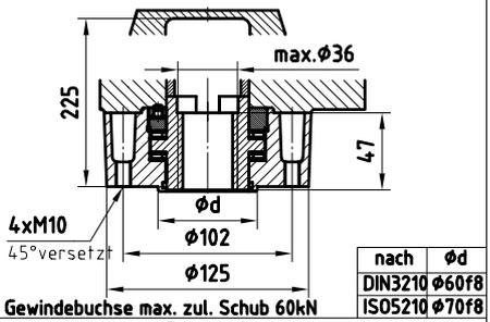
Gewindebuchse max. zul. Schub 60kN
