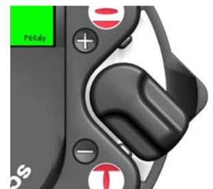
Vollständige Auslenkung des Schalters - der Schalter rastet in dieser Position ein (es wird an das Ende des Menüs gesprungen)
