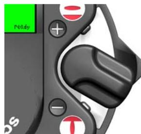
Starke Auslenkung des Schalters (es wird schnell zwischen den Menüpunkten gescrollt)
