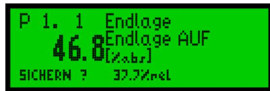
Um die Endlage zu Bestätigen (Sichern) den Wahlschalter kurz nach oben in Richtung schwenken und wieder in die neutrale Stellung federn lassen
