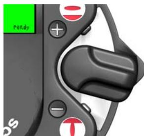
Leichte Auslenkung des Schalters (es wird langsam zwischen den Menüpunkten gescrollt)
